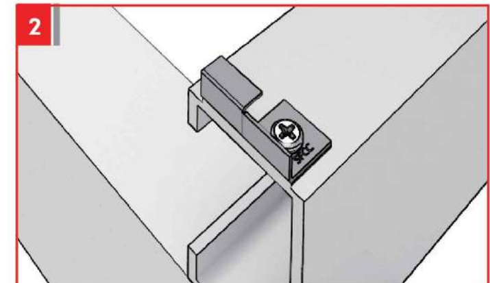
ติดตั้งตัวล็อก ที-คลิป์ ด้วยตะปูเกลียว ปลายส่วน หัวเวเฟอร์ เอสซีจี 13 มม. เข้ากับดงเหล็กทุกอัน
