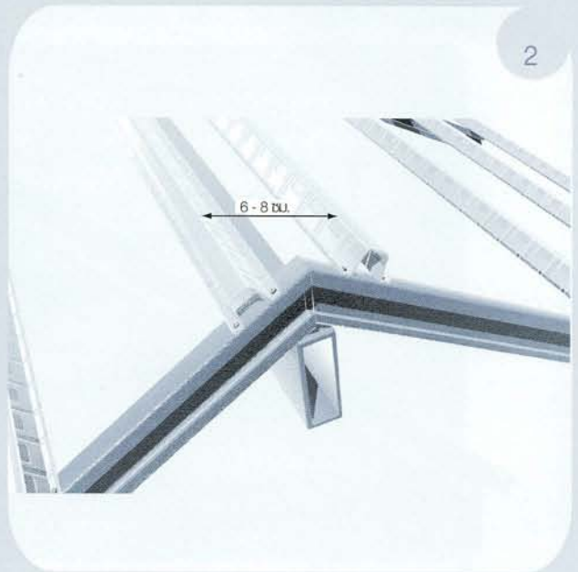
แปคู่บนสุดที่สันหลังคาห่างกันประมาณ 6-8 ซม.
