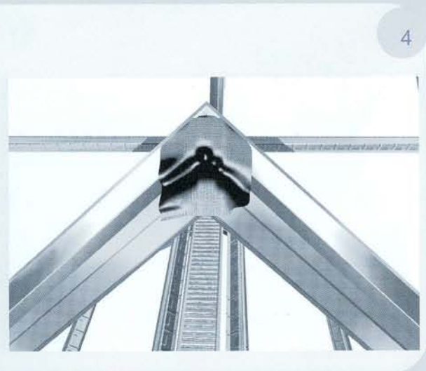
4 หัวรางน้ำทั้งสองด้านที่มาชนกัน ให้ติดเข้ามุมปิดรอยต่อ ด้วยแผ่นปิดรอยต่อ จำนวน 2 แผ่น โดยแต่ละแผ่นซ้อนทับกันประมาณ 5 ซม.
