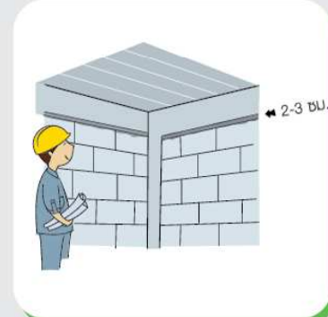
9. เว้นช่องไว้ที่ท่อน้ำไว้ 2-3 ซม. แล้วอุดด้วยปูนทรายทั่วไป
