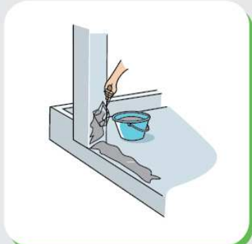
4. ป้ายปูนก่อที่ข้างเสาโครงสร้าง
