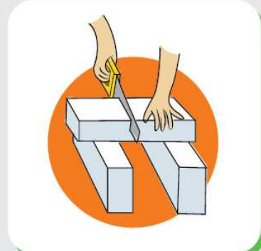
1. ตัดอิฐให้เป็นครึ่งก้อน
