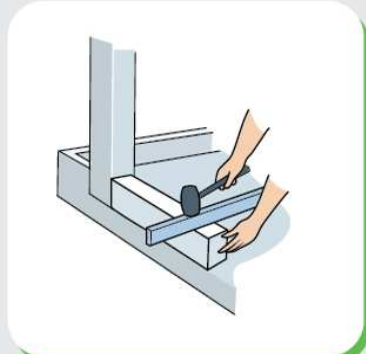
5. การก่อชั้นแรกควรใช้ระดับน้ำ ช่วยในการจัดแนวอิฐ
