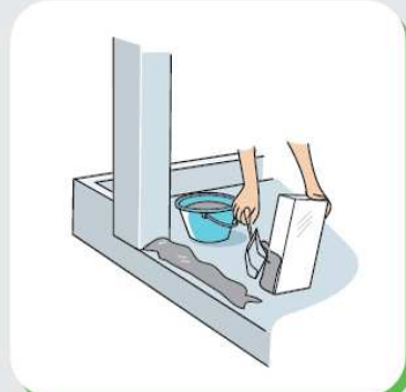
3. ป้ายปูนก่อที่อิฐ บริเวณที่อิฐ สัมผัสกับปูนทราย
