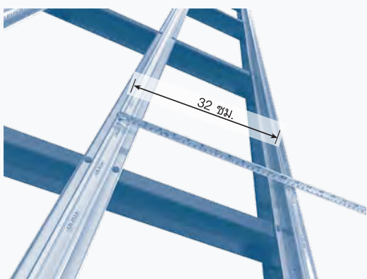
4. วัดระยะจากริมนอกไม้บัวเชิงชาย จนถึงหลังแปเท่ากับ 32 ซม..
